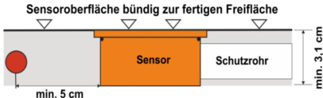
Wenn es sich nicht vermeiden lässt, dass der Sensor beim Aufbringen des Belages bereits montiert ist, muss darauf geachtet werden, dass er nicht durch den Einsatz eines Verdichtungsgerät (z.B. Rüttelplatte) oder z. B. durch das Aufbringen von Gussasphalt mit einer hohen Verarbeitungstemperatur ( $> 75\text{ °C}$ ) beschädigt wird.
