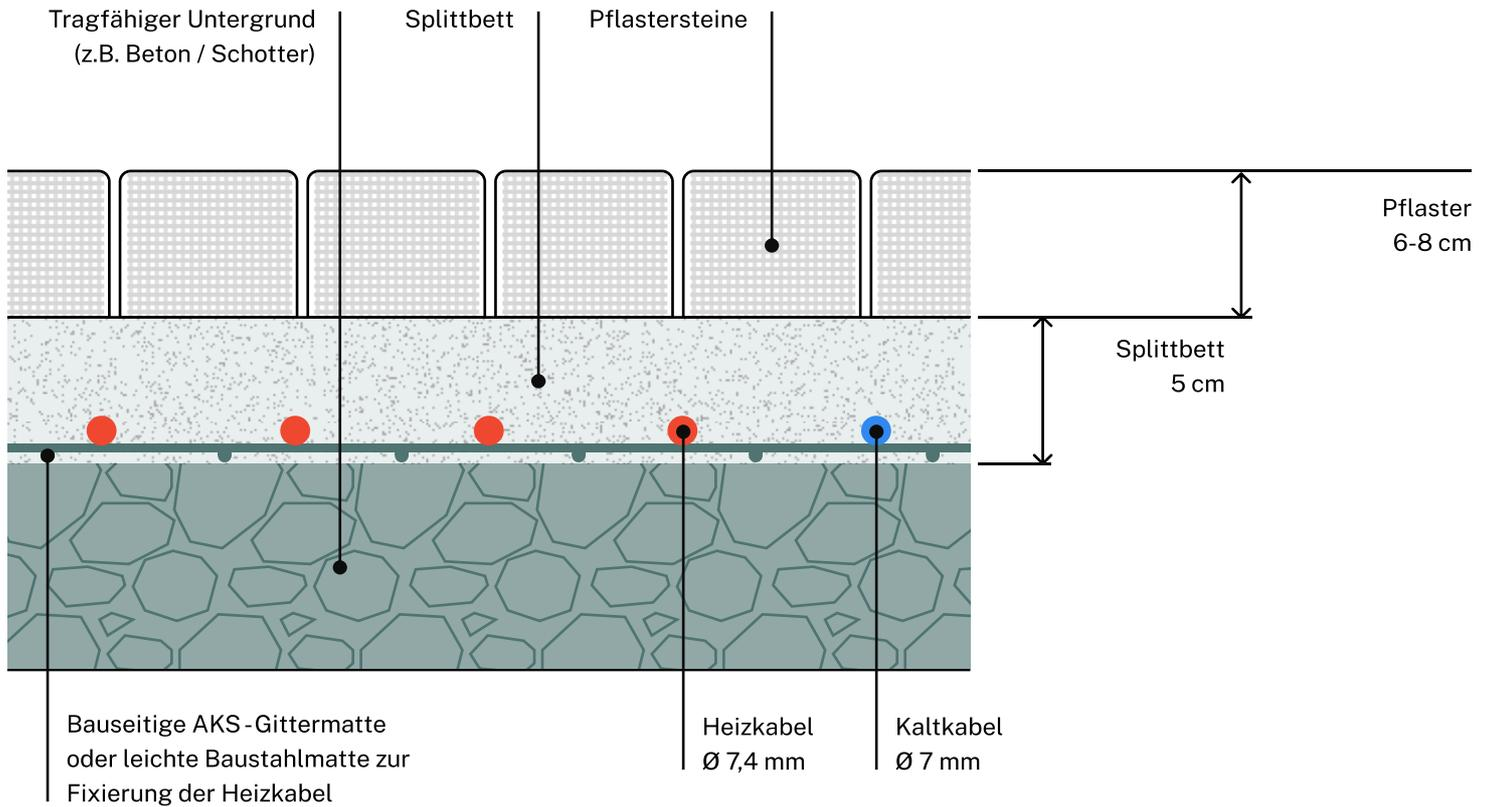
Heizmattenbefestigung auf bauseitigen Baustahlmatten oder Verlegung direkt im Splittbett
