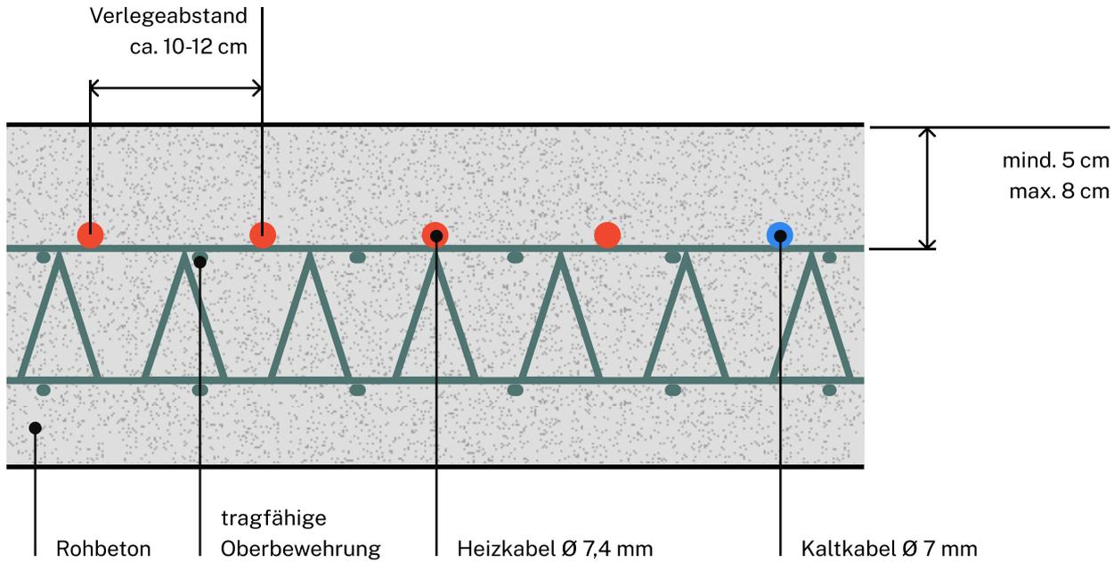
Verlegung der Heizung und Anschlussleitungen auf der obersten, massiven Bewehrungslage
