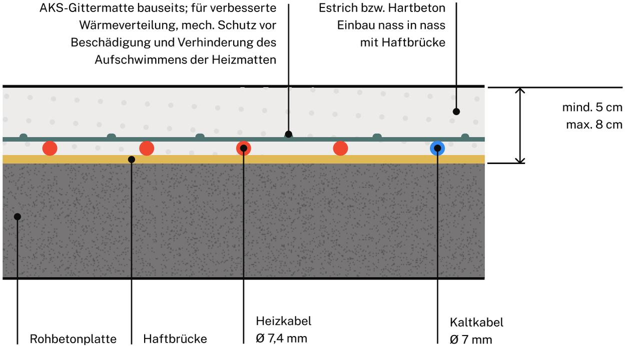
Der Estrichverbund mit der Rohbetonplatte ist zu gewährleisten
